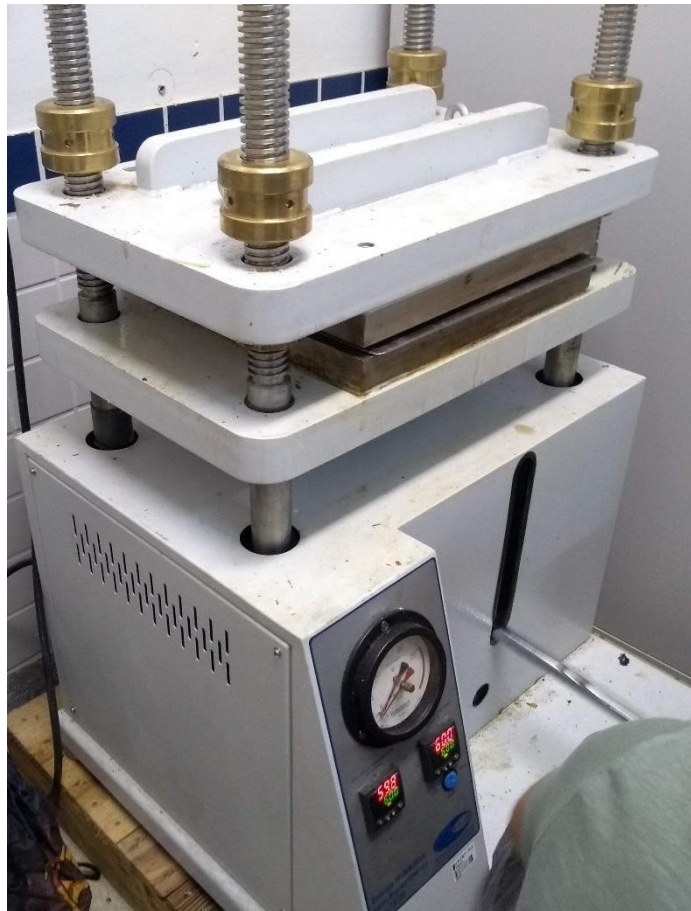
Figura 3.8: Utilização da prensa hidráulica para produção do corpo de prova (C.P.)
