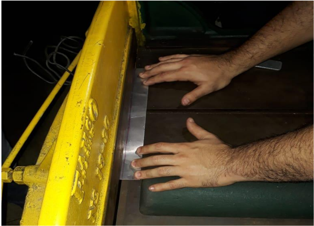
Figura 3.1: Corte das chapas através da guilhotina
