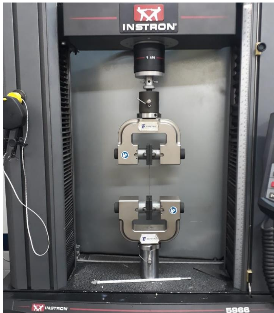
Figura 3.12: Caracterização do fio de SMA com \varnothing 0,5\text{mm} – Ensaio de tração.
